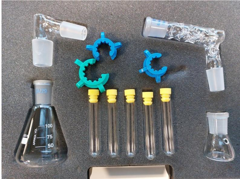
Ce dispositif comprend un réacteur de 100 mL, une colonne Vigreux qui servira pour refroidir les vapeurs générées et un petit réacteur de réception pour recueillir l'huile essentielle et l'eau aromatique.
